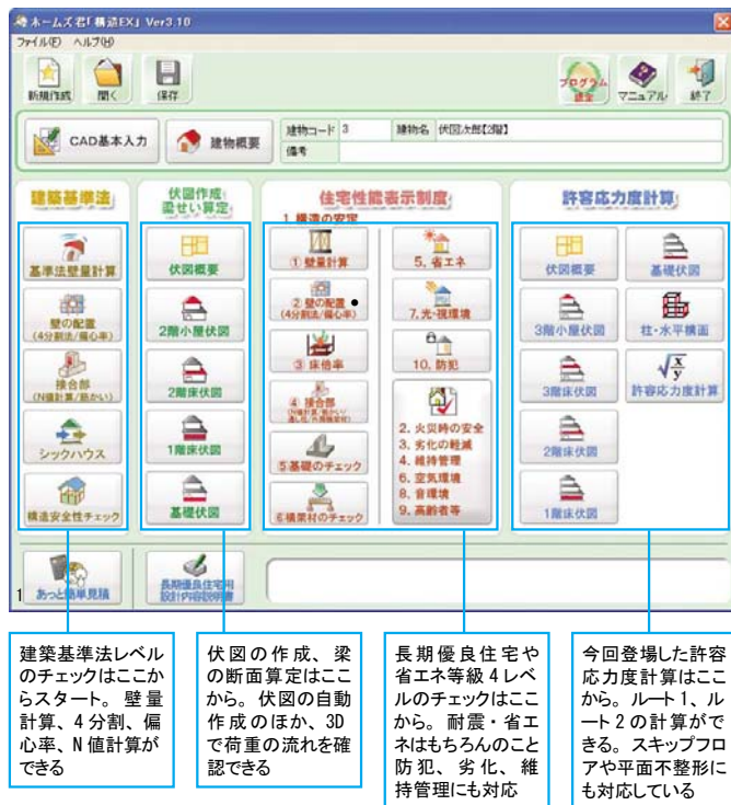
1:ホームズ君構造 EX のメイン画面。ここで、設計する建物で必要とされる法律（建築基準法、性能表示、許容応力度計算）を選んで、伏図の作成や構造強度のチェックを行っていく
